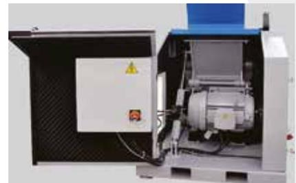
Um die Maschinenabmessungen möglichst kompakt zu halten, wurde der Schaltschrank in die Lärmschutzbox integriert.
