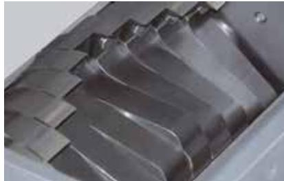
Durch die versetzt angeordneten Rotorsterne sind immer nur einzelne Messer im Einsatz, wodurch eine jeweils höhere Schnittkraft erreicht wird. Sämtliche Maschinen aus der GSL-Baureihe eignen sich somit auch für massivere und dickere Angüsse.
