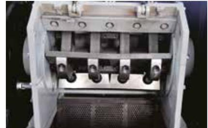
Das Maschinengehäuse sitzt in einer schallgedämmten Box, um einen leisen Betrieb zu gewährleisten. Der Mahlraum und das Sieb sind für die Reinigung und Wartung leicht zugänglich.
