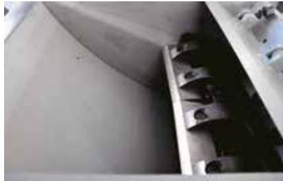
Die tangentielle Schneidkammer gepaart mit dem offenen Rotor-Design sorgt für eine zuverlässige Aufnahme von voluminösen Teilen. Die geschwungene Mahlkammer verringert das Materialstaurisiko.
