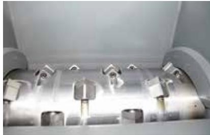
Der sogenannte E-Rotor verfügt über eine glatte Oberfläche. Die Messer werden in Rotortaschen geschraubten Messerträgern gehalten.
