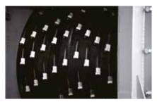
Die Shredder der ZRS-Baureihe verfügen über sehr große Rotordurchmesser mit glatter Oberfläche. Die Messer werden in Rotortaschen geschraubten Messerträgern gehalten.
