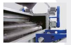
Die Maschine ist mit einem großzügig dimensionierten Beschicktrog ausgestattet, der die Zerkleinerung von Rohren mit einer Länge von bis zu 6 m ermöglicht. Ein leistungsfähiger, hydraulisch gesteuerter Schieber führt das Material zum Rotor.
