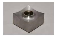
Die Rotoren sind bestück mit quadratischen, konkav geformten Schneidkronen, die für einen sauberen Schnitt und qualitativ hochwertiges Mahlgut sorgen. Nach Abnutzung der Schneidkanten können die Messer gedreht werden.
