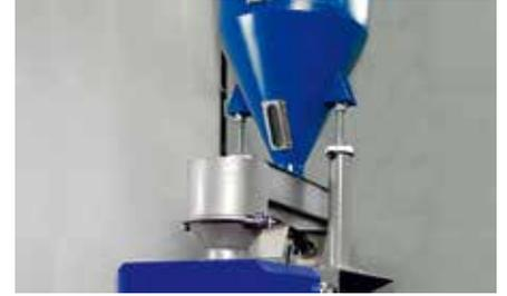
Das Material wird über eine Dosierrinne aufgegeben, die sowohl über die Stromaufnahme des Antriebsmotors als auch über das Temperatursystem gesteuert wird.
