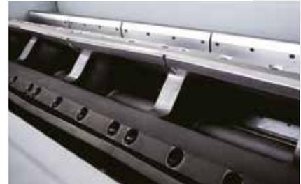
Die GSH 1100-Baureihe ist standardmäßig mit einem massiven H-Rotor ausgestattet, je nach Aufgabenstellung mit 7, 9 oder 11 Rotormesserreihen.
